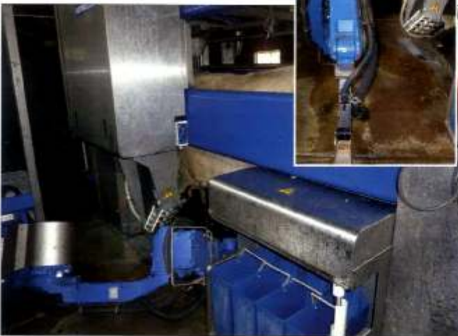
Der Roboterarm beim Ansetzen der Melkbecher. Das kleine Bild zeigt den Roboterarm bei der Reinigung des Vormelkbechers.
